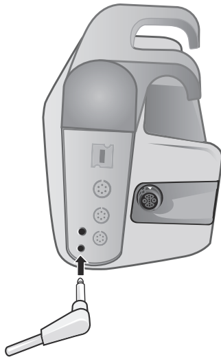
Abbildung 12-1 Anschließen der Temperatursonde an das X Series Gerät
