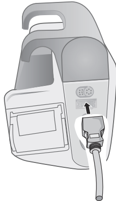
Abbildung 10-3 Anschließen des SpO 2 -Sensors an das X Series Advanced Gerät
